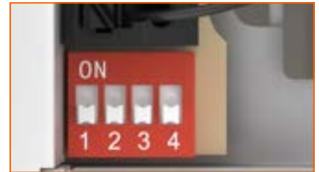
DIP-Schalter zur einfachen Einstellung der Leistungsstufen
